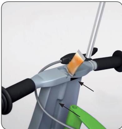
2. Odprite mazivo (B) in namažite krmilno os (A), kontaktne površine sprednje vilice in okvir z 2-3 kapljicami maziva/površino.
